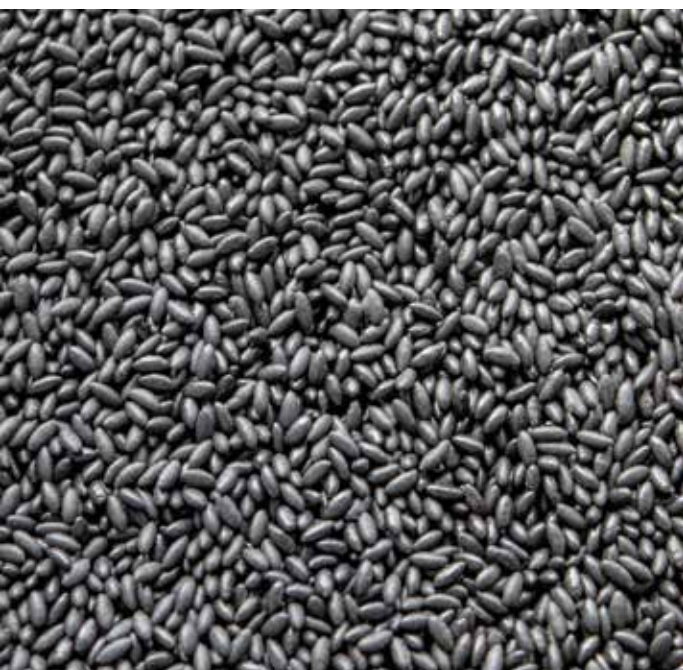
De Greenfill-korrels zijn ovaal, waardoor ze niet in elkaar haken, zoals gemalen materiaal.
